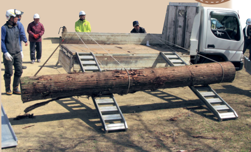
図1 掛け縄方式のしくみ
