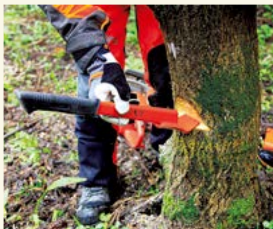
6 フェリングバーを受け口に当てると伐倒方向が予測できる
