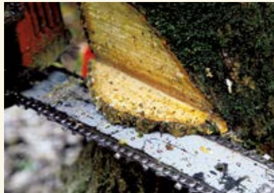
7 下切りで水平を手直しし、接合線をびたりと合わせる。伐倒方向の手直しが必要なときは斜め切りで行なう
