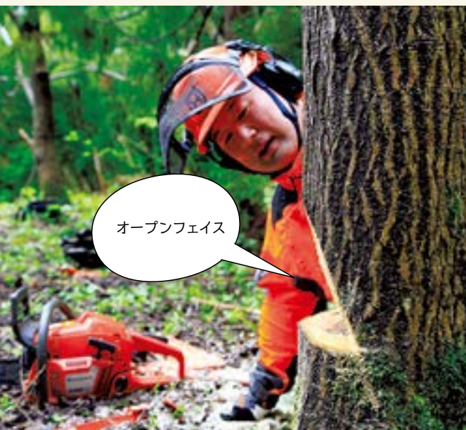
8 受け口は切り込む深さがこれくらい浅いほうがよい。ただし角度は大きいほうが、つるが最後までつながるので安全に倒れる。大きい角度の受け口を「オープンフェイス」ともいう
