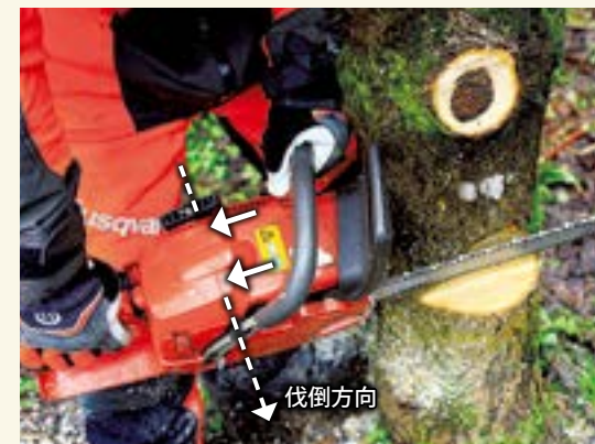
3 これが斜め切り。チェンソー本体に刻まれたライン(バーと垂直の線: 矢印)を目安に伐倒方向に合わせて切るのがポイント
