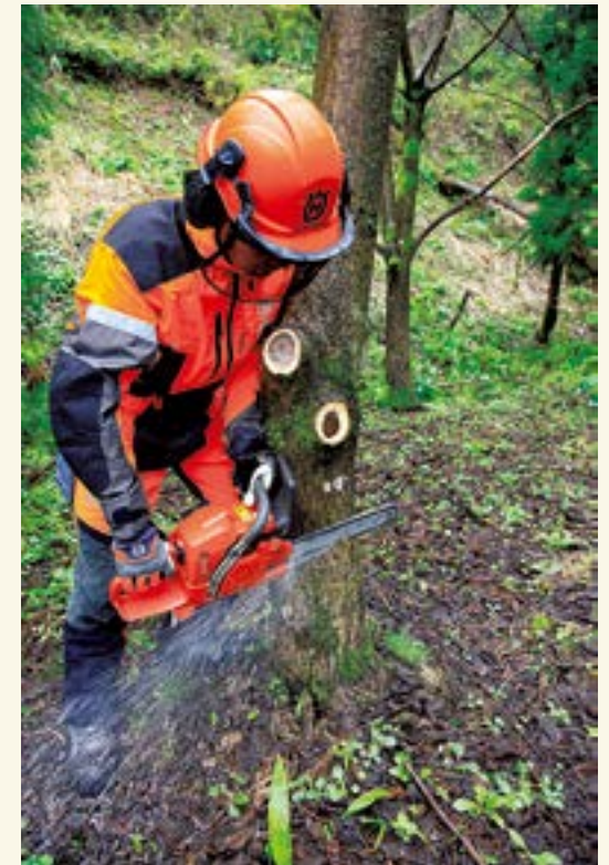
1 木に体を寄せて倒したい方向を見て確認しながら斜め切りする。「斜め切り」と「下切り」どちらからでもよいが、斜め切りからのほうが切り過ぎることがないのでおすすめ。受け口は一発で作ろうとせず、2~3回手直ししながら作るとうまくいく。最初は小さめに
