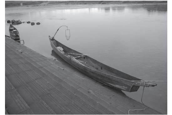
図2 小瀬鶺飼の鶺舟。船外機は使わず、竿と櫂だけで行き来する(写真提供:関市)
