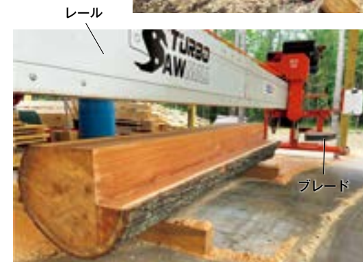
レールに据え付けられたブレードの往復だけで板や角材を正確に製材できる。丸太を置き換える必要もない
